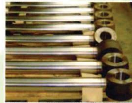
• **Grâce à la possession de la double technologie**, ici un rotor de compresseur nickelé (intégral) puis chromé (portées de paliers).
