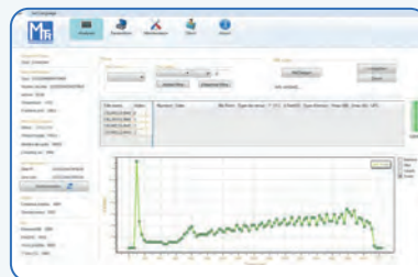
Logiciel permettant le paramétrage de l'outil, l'enregistrement des données de sertissage ainsi que l'analyse des cycles effectués.
