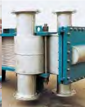
Réchauffeur de liqueur de zinc
