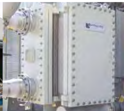
Platulaire type X 4 portes sur eaux blanches de papeterie
