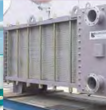
Refroidisseur d'effluent de papeterie
