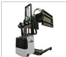
Spécifiquement adapté aux secteurs agroalimentaires ou pharmaceutiques, ce type de machine permet de remplacer les palettes bois par des modèles Inox ou plastiques.
