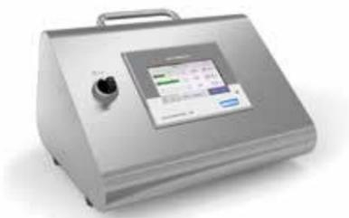
Le LEAK-MASTER® EASY permet la détection des plus petites fuites sans recourir aux gaz traceurs. Le principe repose sur une méthode bien connue et intuitive de détection des fuites : la visualisation de bulles d'air dans l'eau. L'emballage à tester est placé dans une chambre remplie d'eau et maintenu sous l'eau par une plaque transparente.
