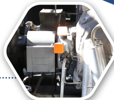
Speed-care: Dans le milieu de la vibration, pour pouvoir effectuer un bon diagnostic, il est important de connaître la vitesse de rotation exacte de la machine. C'est pourquoi l'équipe Wi-care™ a développé le premier capteur de vitesse sans fil au monde.
