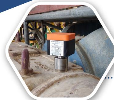
Triax-care: afin d'améliorer la qualité du procédé de surveillance de votre machine, les ingénieurs Wi-care™ ont révisé le Vib-care avec un capteur tri-directionnel. De plus, l'outil garde les mêmes capacités de mesure que le Vib-care avec la température.
