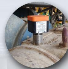
Le Triax-care fonctionne sur base du même principe que le Vib-care à la différence qu'il analyse les données de la machine selon 3 directions : verticale, axiale et horizontale. Grâce au Triax-care, on peut choisir de synchroniser les mesures selon l'une ou l'autre direction (ou les 3 en même temps).
