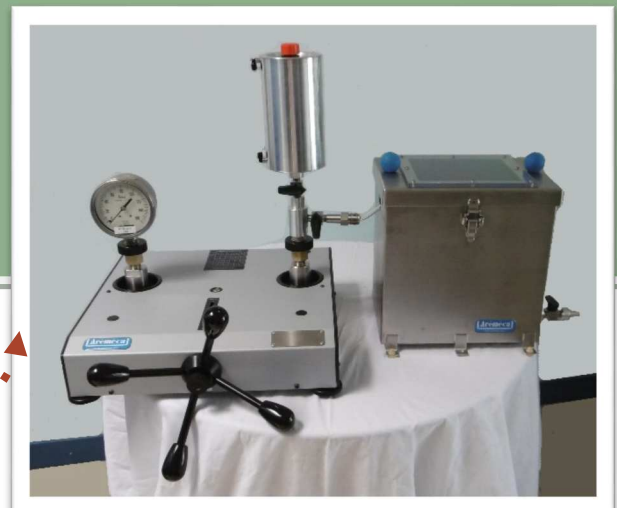
Ex : Banc de test d'éclatement de pièces
