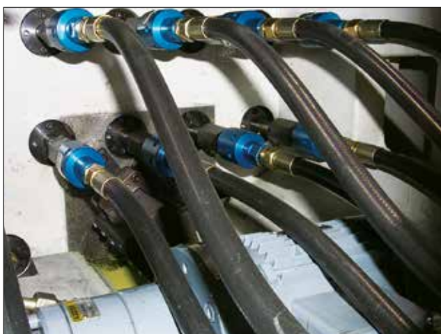
Joints Tournants DEUBLIN 1116 supportés à roulements sur ligne transfert automobile.
