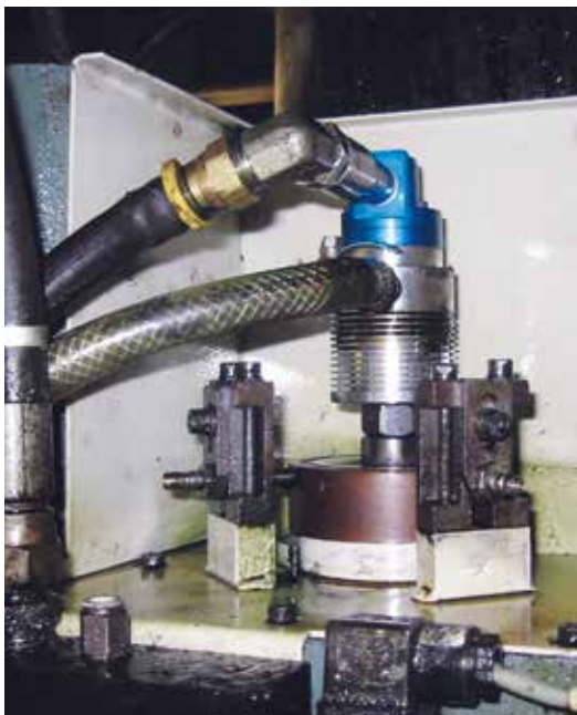
DEUBLIN 1109 sur centre d'usinage vertical.
