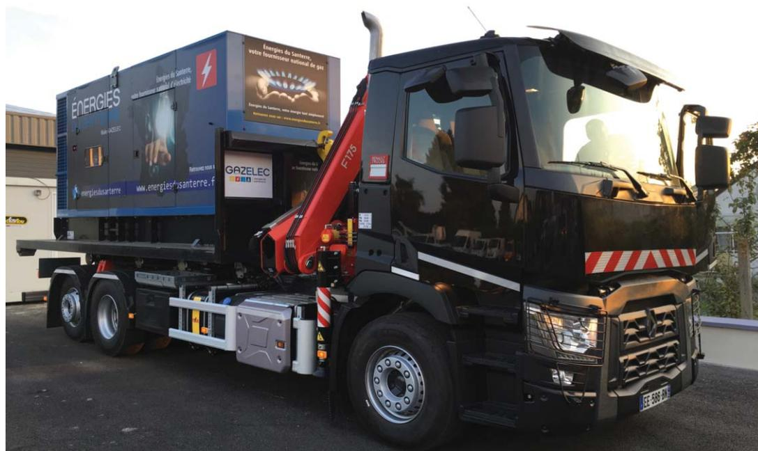
Camion multifonctions équipé d'un groupe électrogène.
