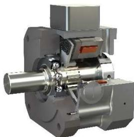
Selon la conception de cette dernière, il existe plusieurs possibilités pour l'intégration ou la réadaptation de freins de sécurité. Le premier emplacement possible se trouve entre le servomoteur et l'axe. Le ROBA<sup>®</sup>-topstop<sup>®</sup> peut y être installé comme module indépendant. Il maintiendra efficacement l'axe dans n'importe quelle position même si le moteur doit être démonté pour raison logistique ou de maintenance.
