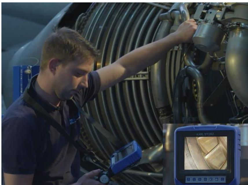
**Produits spéciaux :** *Vidéoscope UV* pour le contrôle par ressuage, *endoscopes haute température*. (Nous consulter)
