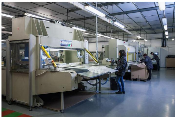
Une nouvelle machine de découpe automatique a été acquise- d'une capacité de 150T et de 150 cp/minutes nous permet de gagner encore en précision et rapidité.
