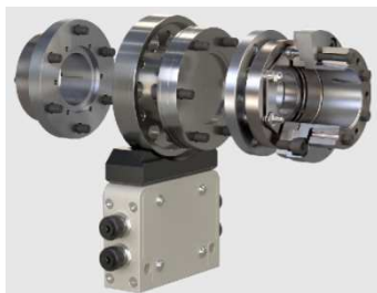
Fig 1 : Les accouplements sans-jeu et à rigidité torsionnelle ROBA®-DS à paquets de lamelles compensent les désalignements d'arbres. Ils assurent ainsi des mesures précises et protègent également les roulements montés sur l'arbre d'usure prématurée.
