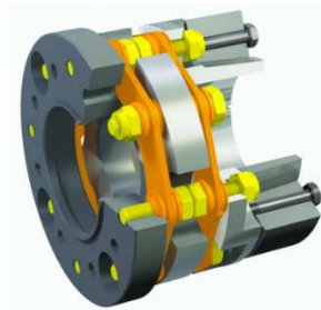
Fig 1 : Les accouplements sans-jeu et à rigidité torsionnelle ROBA®-DS à paquets de lamelles compensent les désalignements d'arbres. Ils assurent ainsi des mesures précises et protègent également les roulements montés sur l'arbre d'usure prématurée.
