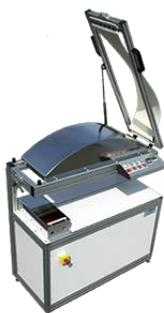
Cette machine de laboratoire est capable de presser et de sécher des feuilles de papier similaires à des feuilles industrielles. Associée à la machine Mécaform, c'est le meilleur dispositif qui crée une orientation de fibre.
