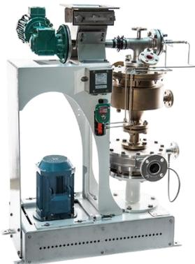
Première machine conçue et fabriquée par EP MECA pour la société SNF (brevetée et commercialisée en son nom), les PSU sont utilisés dans l'industrie pétrolière, pour l'injection contrôlée de polymère dans les sols.
