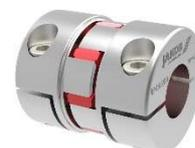
Nos accouplements compensateurs permettent un transfert de couple précis et sans jeu, ils offrent une grande rigidité et une grande résistance à la torsion ainsi qu'un faible moment d'inertie. Les éléments de compensation comme l'insert polyuréthane ont la capacité de compenser les défauts d'alignement.
