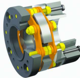
Fig 1 : Les accouplements sans-jeu rigides en torsion ROBA®-DS à paquets de lamelles compensent les désalignements d'arbres. Ils assurent ainsi des mesures précises et protègent également les roulements montés sur l'arbre, d'usure prématurée.
