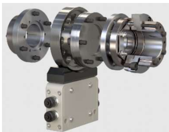
Fig 1 : Les accouplements sans-jeu rigides en torsion ROBA®-DS à paquets de lamelles compensent les désalignements d'arbres. Ils assurent ainsi des mesures précises et protègent également les roulements montés sur l'arbre, d'usure prématurée.
