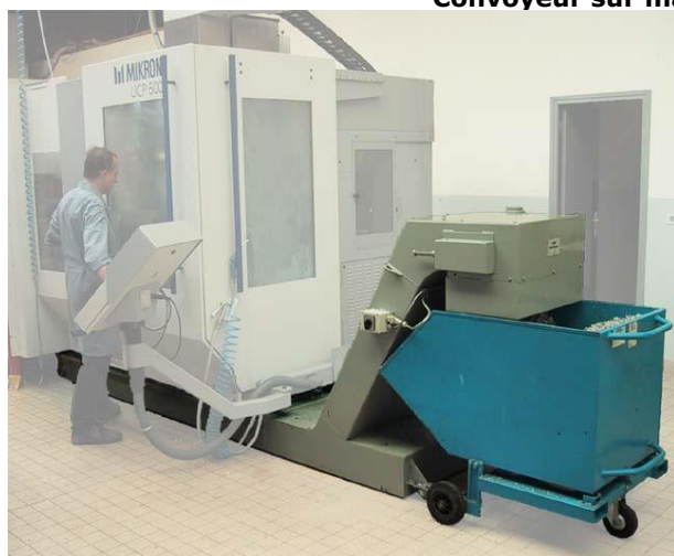
Convoyeur pour machine Micron UCP 600 - Murata MW 20 sortie Arrière
