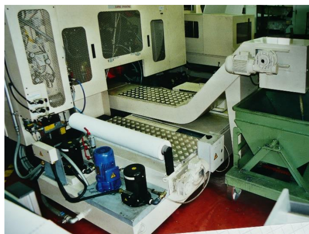
Convoyeur pour machine Micron UCP 600 - Murata MW 20 sortie Arrière
