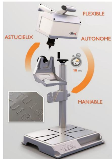
Cet équipement de marquage permet un marquage permanent sans créer d'amorce de rupture sur tous types de pièces, surfaces et matériaux ayant une dureté inférieure ou égale à 63HRC.
