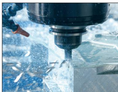
La broche Haas en ligne avec entraînement direct de 12 000 tr/min est reliée directement au moteur pour réduire les vibrations ainsi que le dégagement de chaleur et les bruits. Le double entraînement vectoriel de 22,4 kW permet d'obtenir un couple suffisant à basse vitesse ainsi que la vitesse nécessaire pour l'usinage à grande vitesse.
