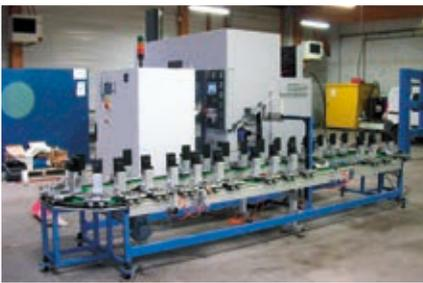
**Outils à cassette pour contrôle étanchéité tuyauterie automobile**
