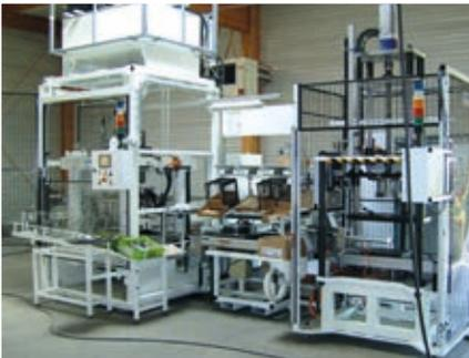
**Montage de la structure mécano-soudée assemblée pour une machine 4 axes numériques avec pilotage logiciel FAO**
