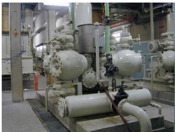
Presque une solution standard : le remplissage du filtre-pressé avec la SM-G-HH 304
