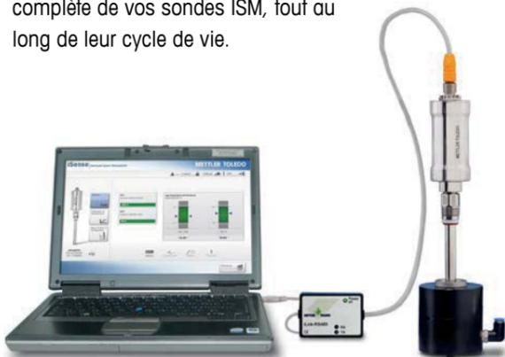
Logiciel iSense étalonnant une sonde de mesure de l'oxygène dissous
