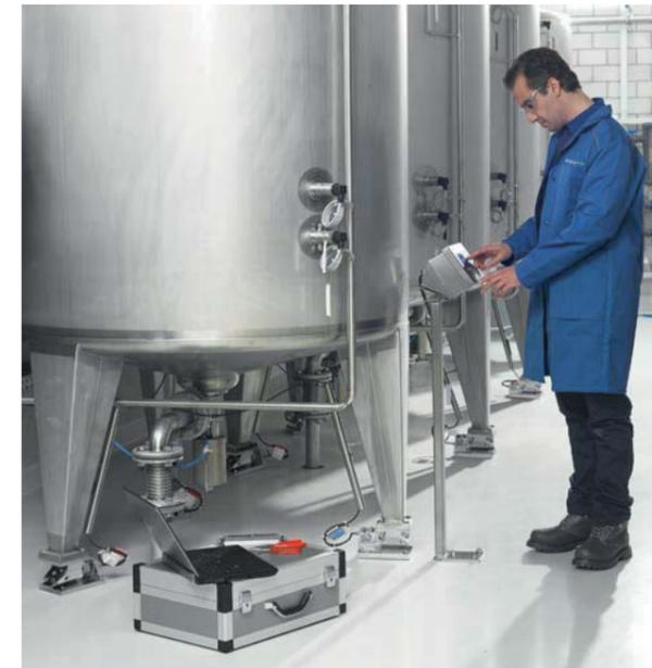
deuxième étape, les poids de contrôle sont ajoutés pour atteindre 40 % de la portée maximale. Les poids de contrôle sont ensuite remplacés. Cette opération est répétée jusqu'à atteindre 100 % de la portée maximale.
