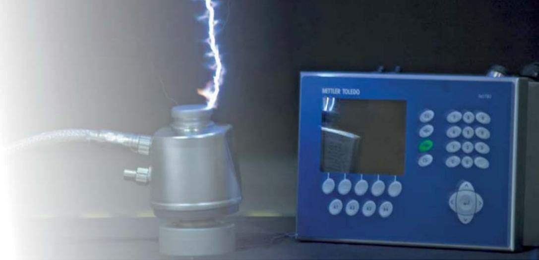
Tests de protection contre la foudre réalisés en laboratoire
