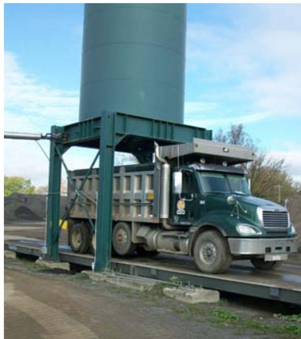
Les opérations de remplissage peuvent utiliser un pont-bascule pour camions comme mesure principale pour la distribution.
