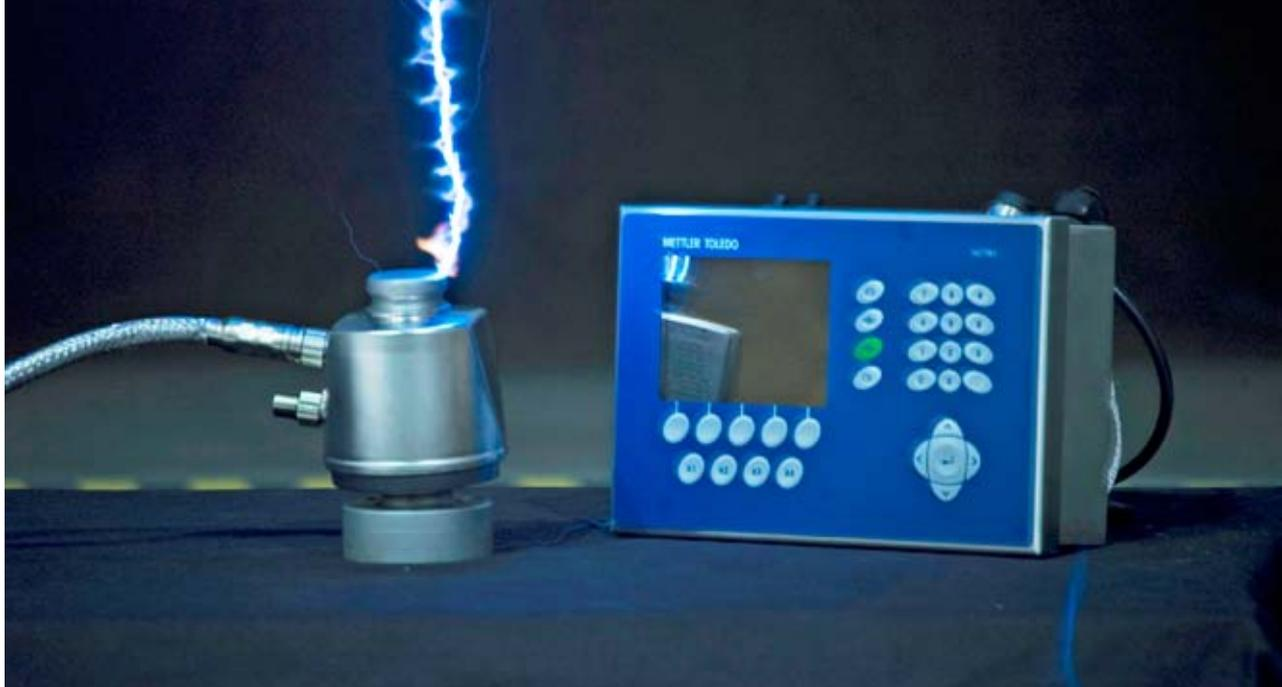
Une cellule de pesée POWERCELL® PDX® connectée à un terminal IND780 lors d'un test de foudroiement
