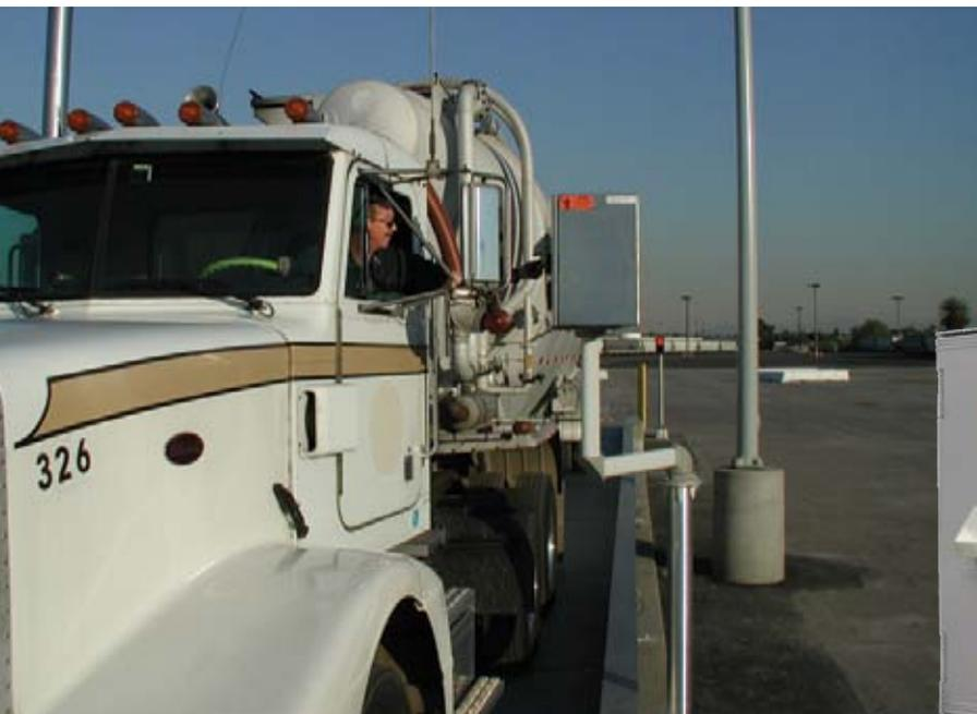
Les terminaux sans surveillance permettent aux conducteurs d'effectuer leurs propres opérations de pesage
