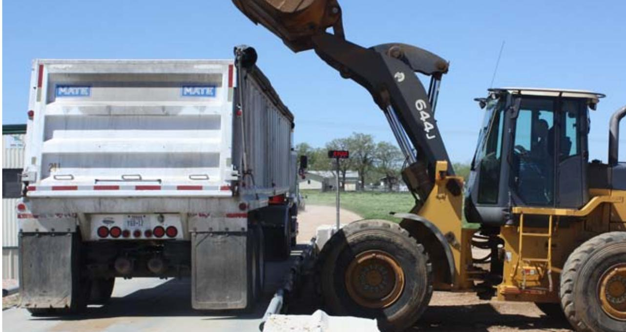
Un écran d'affichage du poids à distance monté dans le champ de vision de l'opérateur du dispositif de chargement permet de remplir ce camion jusqu'à la limite maximale du poids routier.
