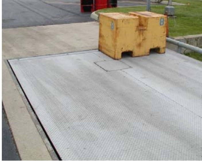
Un poids de contrôle sur un angle d'un pont-bascule
