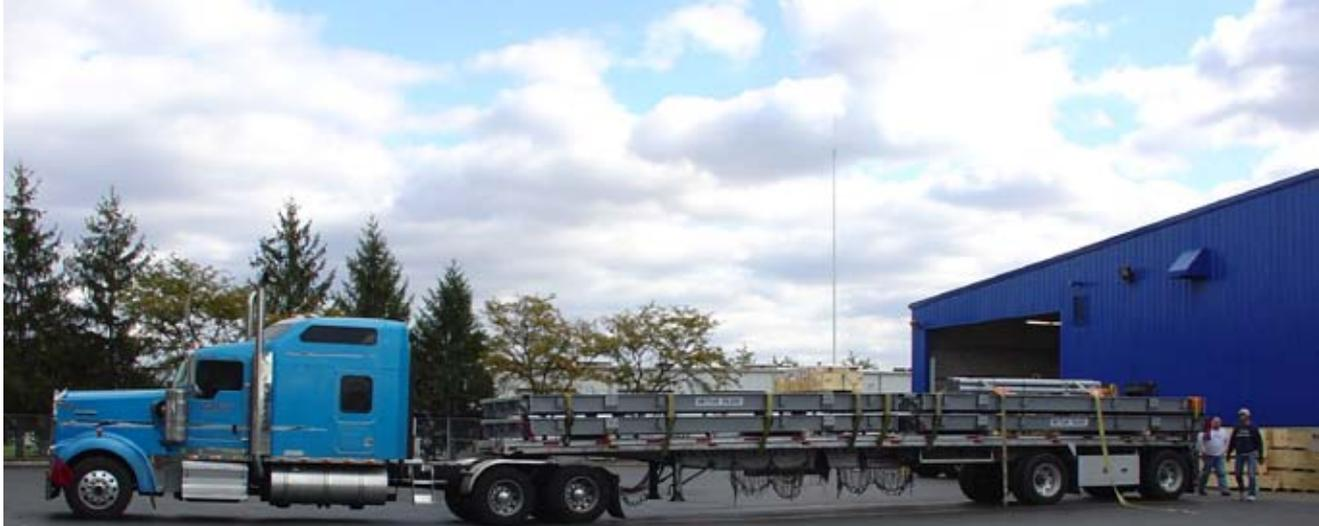
Le transport des modules de la plateforme sur une remorque à plat est courant dans certaines régions, bien que la largeur des modules puisse nécessiter une désignation « charge surdimensionnée » du camion.
