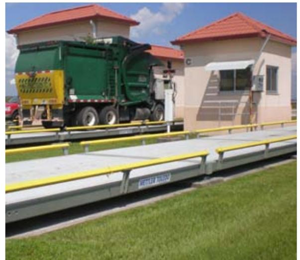
Une guérite de pesage peut servir à plusieurs fins, notamment l'exploitation du pont-bascule, le traitement des transactions et la sécurisation du site.
