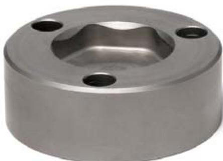
Par exemple, le système anti-rotation de METTLER TOLEDO comprend une forme hexagonale dans les réceptacles de cellule de pesée qui empêche tout pivotement de la cellule de pesée.
