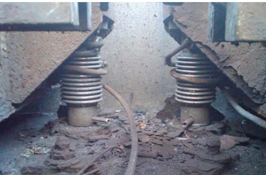
Si les caractéristiques d'anti-rotation d'une cellule de pesée de type à compression sont insuffisantes, le câble peut finir par s'enrouler autour de la cellule de pesée et se rompre.
