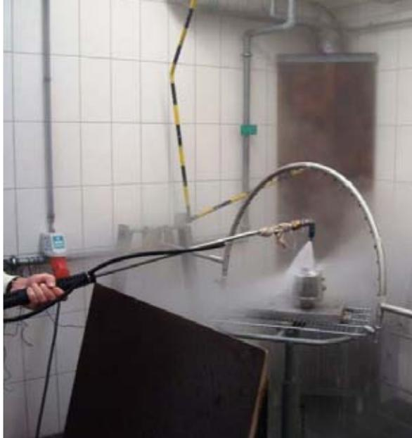
Une cellule de pesée POWERCELL® PDX® subissant un test IP69K à l'aide d'un jet sous pression
