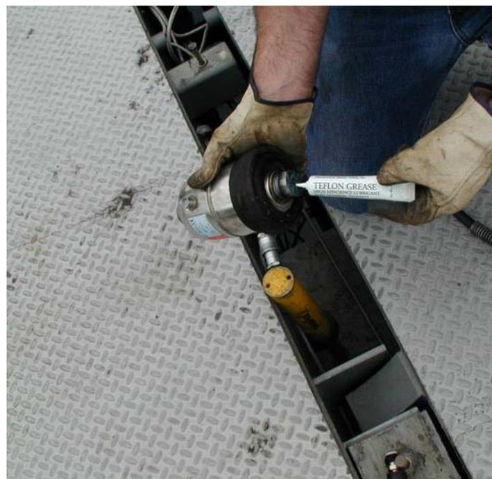
Certaines zones, comme les surfaces d'ajustement de la cellule de pesée, nécessitent une lubrification périodique.
