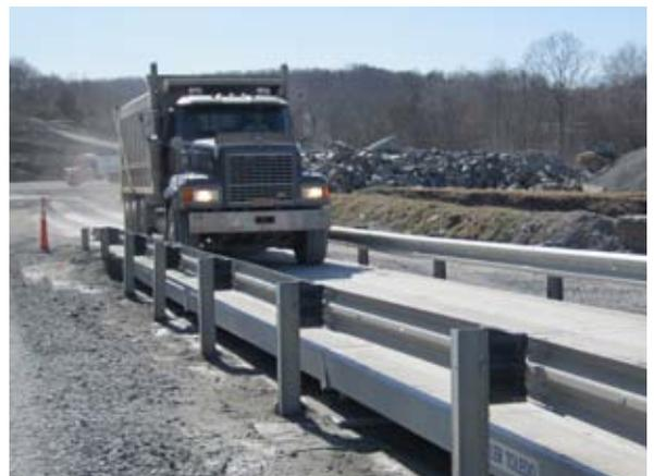
Les sites de production de granulats, par exemple, peuvent trouver qu'il est plus facile de nettoyer les déversements de produits sur un pont-bascule ouvert sur les côtés.
