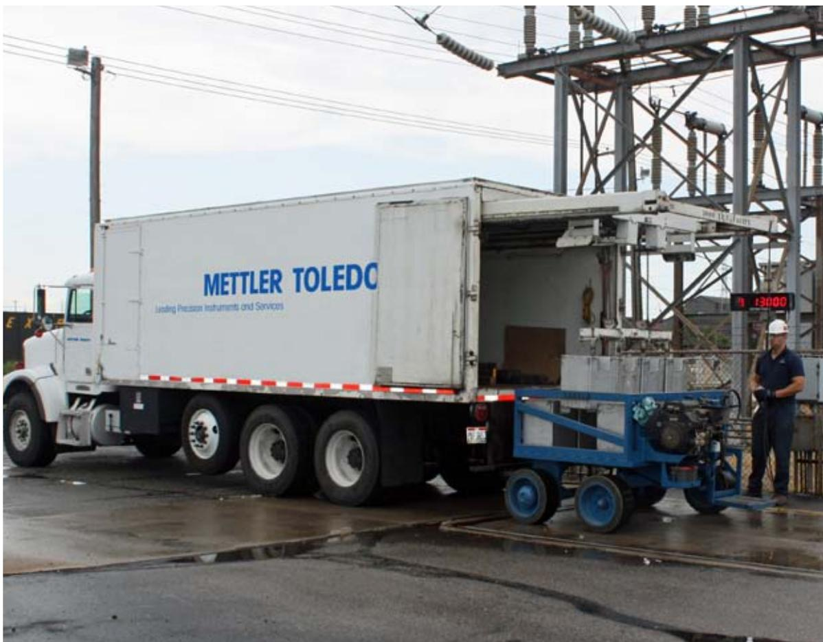
Une vérification de l'étalonnage peut être effectuée à l'aide de poids de contrôle de grande taille chargés sur un chariot motorisé. Le technicien déplace le chariot en divers points du pont-bascule avec différentes quantités de poids pour tester l'homogénéité de la précision du pont-bascule.
