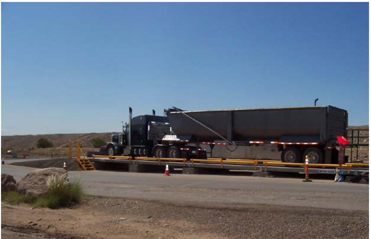
Entretien la propreté de la zone où est installé le pont-bascule permet d'éviter les erreurs de pesage causées par des débris.
