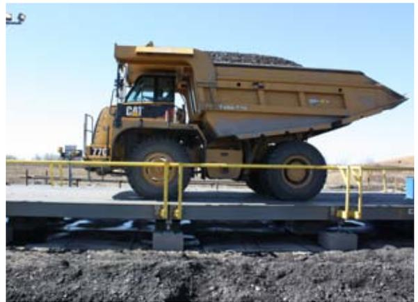
Un modèle de pont-bascule ouvert sur les côtés peut faciliter l'entretien.
