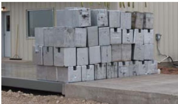
Poids de contrôle sur un pont-bascule
