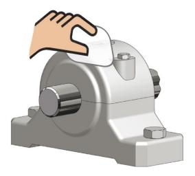
② Retirez le graisseur ou la vis de fermeture du filetage de raccordement et déterminez la taille de filetage.
