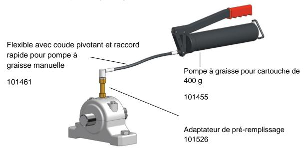
En cas de montage indirect effectuer un pré-remplissage du point de graissage et des conduites flexibles.
