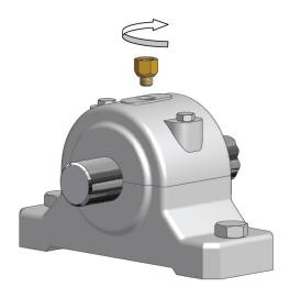
4 Effectuer une pré-lubrification du point de graissage et de toutes les pièces de raccordement et flexibles.
