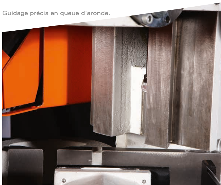
Fonction semi-automatique, étau pneumatique.
