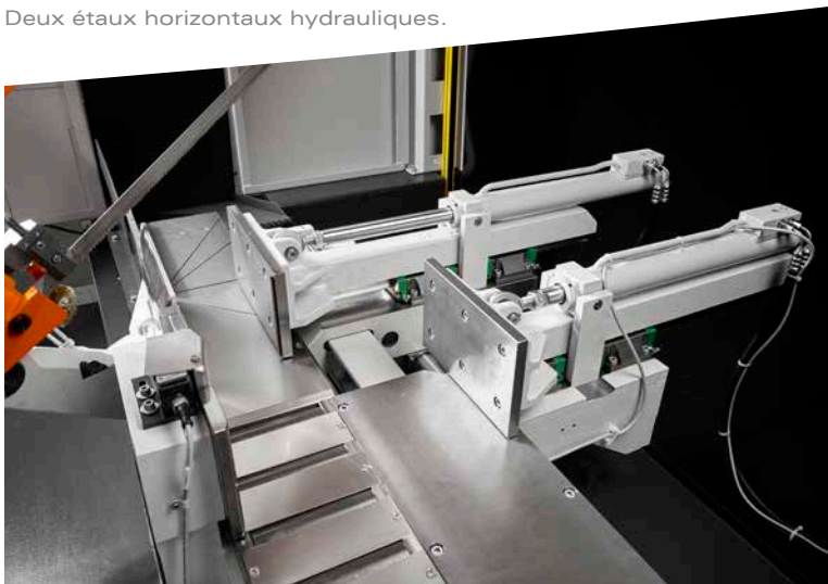
Deux étaux horizontaux hydrauliques.
