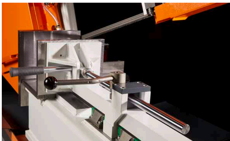
Serrage matière via étai se déplaçant au-dessus de la ligne de coupe à guidage linéaire.
