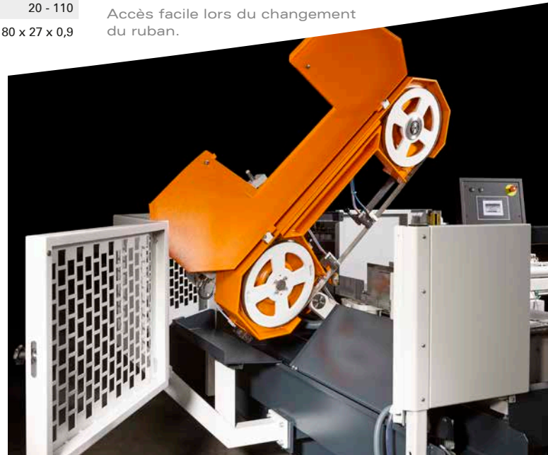
Cartérisation complète de la machine selon les règlements les plus récents.
