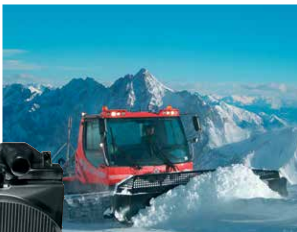
Echangeur combiné air/eau et air/air de suralimentation pour dameuse „PistenBully 600“, Kässbohrer
