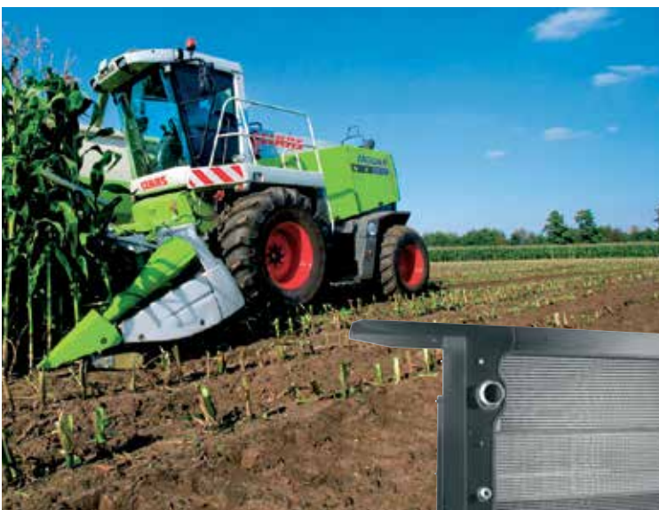
Echangeur combiné air/eau, air/air de suralimentation et air/huile pour l'ensileuse „Jaguar 900“, Claas
