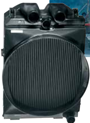
Echangeur combiné air/eau et air/air de suralimentation pour dameuse „PistenBully 600“, Kässbohrer
