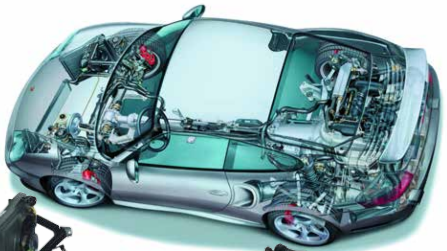
Module de refroidissement haut rendement pour le refroidissement moteur „Porsche 911 turbo“
