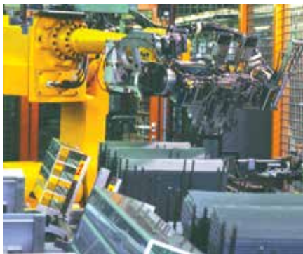
Assemblage robotisé des blocs d'échangeurs
