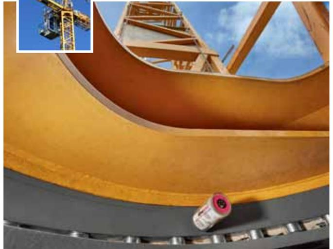
Les graisseurs simalube 125 ml lubrifient l'ensemble rotatif d'une grue.
