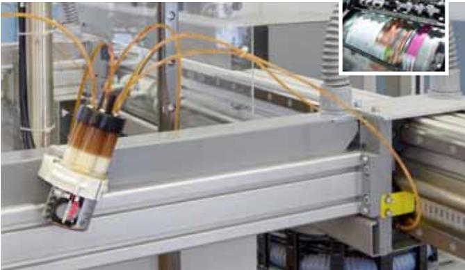
Un simalube multipoint peut lubrifier 5 guidages linéaires d'une machine d'empilage et de coupe du papier dans une imprimerie.
