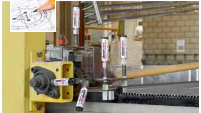
Des graisseurs simalube 15 ml avec des brosses approvisionnent continuellement en huile la crémaillère d'une machine de chargement. Des graisseurs supplémentaires simalube 15 ml lubrifient les paliers à bride avec de la graisse.
