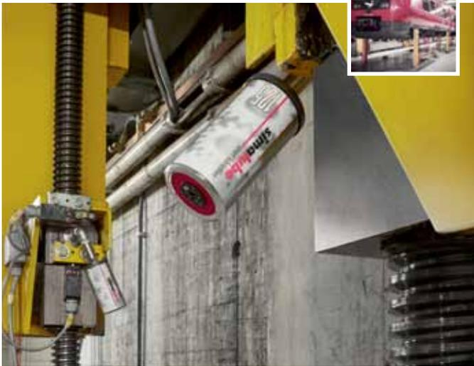
Les broches d'une station de levage pour des wagons et des locomotives ferroviaires sont lubrifiées avec simalube 125 ml sur 12 mois.
