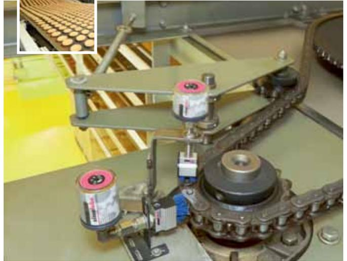
La chaîne d'entraînement d'un tapis de transport, qui sert à faire refroidir les petits pains, est nettoyée avec des brosses spéciales bleues et lubrifiée avec 2 simalube SL18 en taille 30 et 60 ml.
