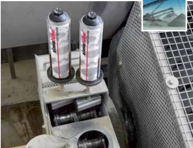
Deux graisseurs simalube 250 ml avec des brosses nettoient et lubrifient la chaîne d'entraînement d'une machine à laver à tambour.
