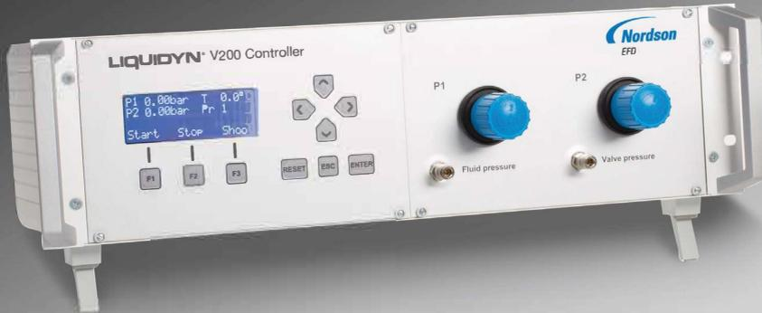
Le contrôleur Liquidyn V200 assure un fonctionnement simple et sûr des valves de jetting Liquidyn P-Jet CT et P-Dot CT et un meilleur contrôle sur les résultats de dépose. En garantissant un contrôle des paramètres de dosage, le Liquidyn V200 permet d'optimiser les performances de la valve. Deux régulateurs de pression de précision et un affichage digital permettent un réglage facile des paramètres pour obtenir la dépose parfaite.
