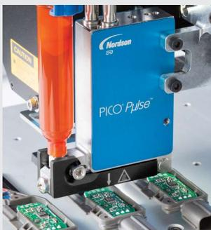
Les systèmes de valve de jetting Nordson EFD offrent une vitesse et une précision inégalées pour la dépose sans contact, même dans le cadre des applications les plus complexes.
