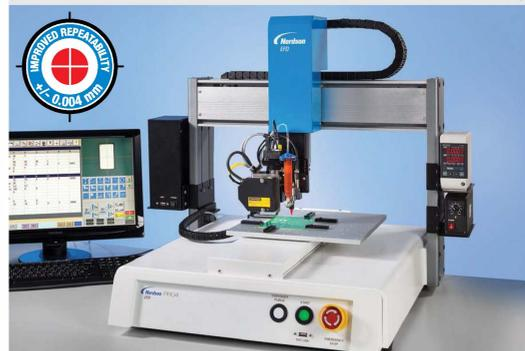
La Série PRO, équipée d'un système de vision et d'un laser intégrés, offre une solution automatisée complète.
