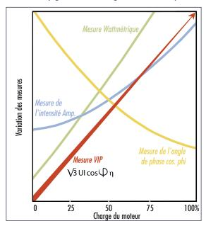
La mesure VIP s'exprime en une droite directement proportionnelle à la charge du moteur, en parfaite corrélation avec la courbe hydraulique Débit/Pression de la pompe contrairement aux mesures classiques wattmétrique, d'intensité ou cosinus Phi.
