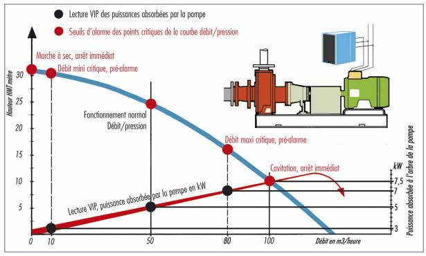
Exemple de détection sur une pompe centrifuge avec la méthode de mesure du couple résistant VIP : corrélation précise des points de courbe débit/pression d'après la puissance délivrée à l'arbre de la pompe (sans capteur ni sonde).
