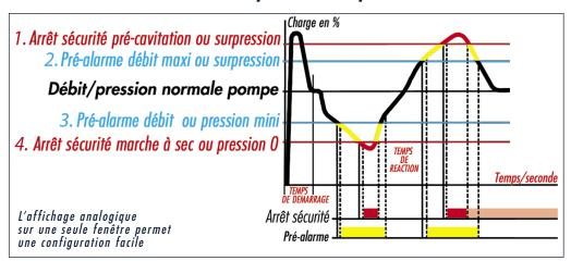
Exemple d'alarmes sur pompes volumétriques et centrifuges
