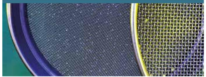
Capable de résister à de fortes pressions de fonctionnement, les filtres pour extrudeuses caoutchouc, plastique et aluminium ont également le pouvoir de mélanger la matière au moment de la filtration. Diamètre des tamis de 5 mm à 650 mm composés d'une ou plusieurs toiles métalliques assemblées par soudure électrique. Cylindre filtrant. Maille tissage Carré ou Repts pour les fortes pressions et le compoundage. Ces tamis sont également utilisés dans l'extrusion alimentaire (pâtes et savons).
