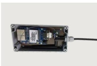
Boîtier Wifi pour la connexion à l'interface série, avec une consommation d'énergie économique optimale même pour les systèmes alimentés par batterie.
