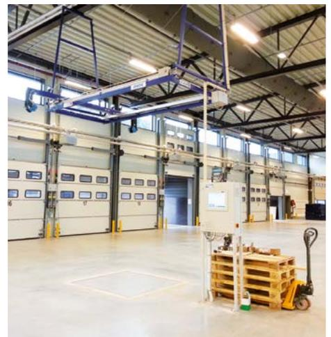
Module plafonnier, bascule au sol intégrés, module de commande
