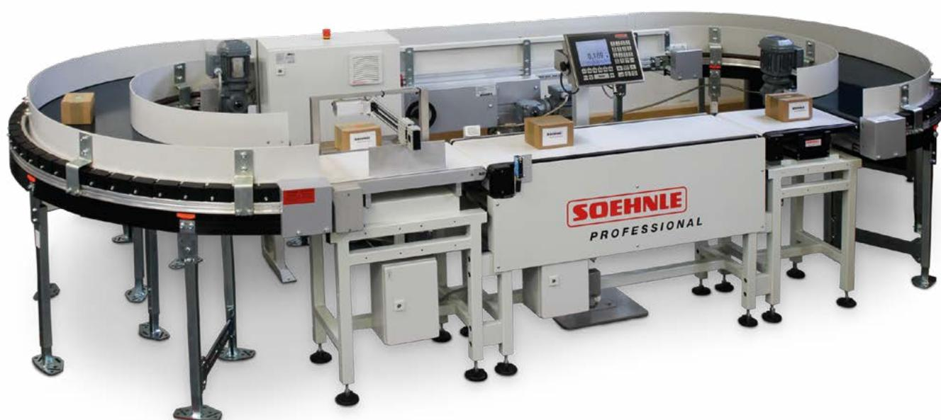
Illustration: Système d'essai et de développement en convoyeur circulaire pour l'optimisation du pesage et du dimensionnement dynamique
