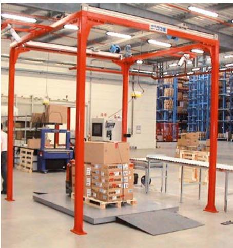
Portique de mesure volumétrique avec rampe d'accès
