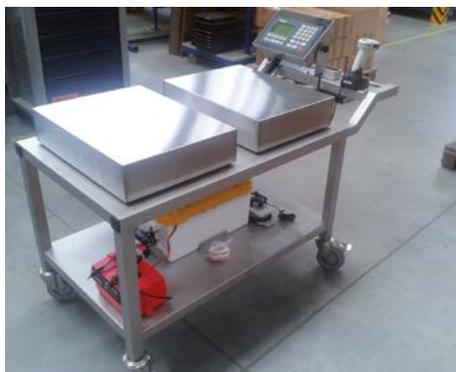
*Balance double sur châssis mobile avec galets, lecteur de code-barres et alimentation par batterie*
