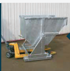
Passage transpalette entre les fourreaux
