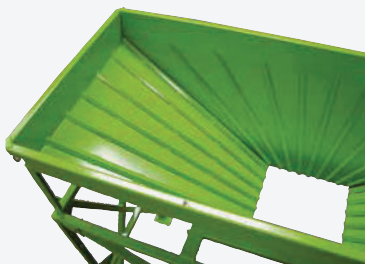
Renforts par cornières anti-poinçonnement
