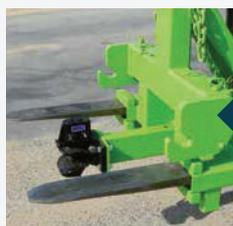
Flèche avec crochet automatique et fourreaux ouverts
