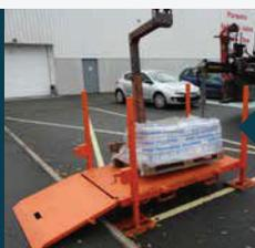
Dépose de la palette sur la rampe
