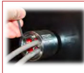
6 - Serrer les vis en croix en suivant les instructions de serrage suivant tableau
