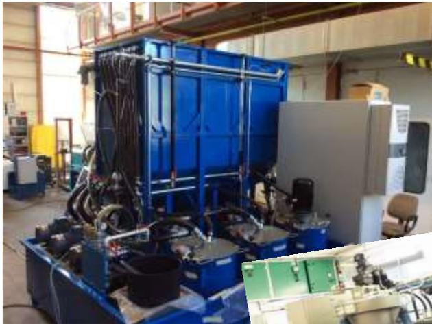
Installation centralisée de filtration d'huile de frappe avec 3 centrifugeuses manuelles
