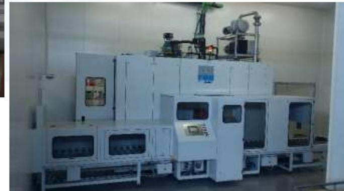
Machine de nettoyage-dégraissage ROLL RCTS 067 avec 2 bains de nettoyage « BONTAZ Centre » au solvant Non Chlore DOWCLENE 1601
