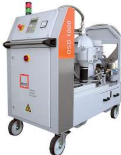
Centrifugeuses mobiles manuelle à tambour à 2 ou 3 phases. Filtration jusqu'à 5 µ, débit de 800 à 3000 L/Heure.
