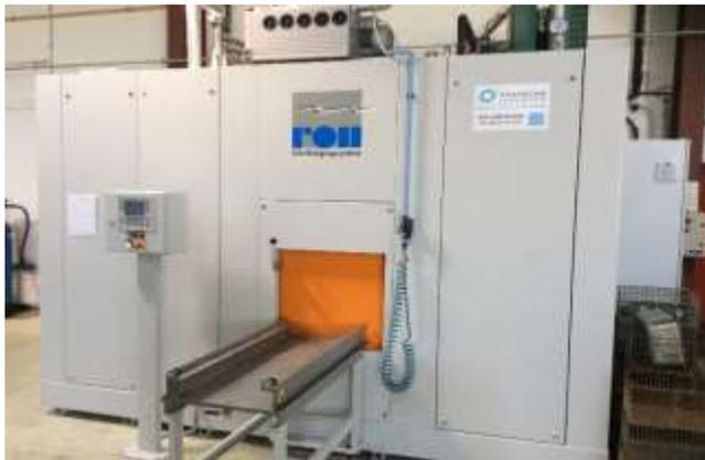
Machine de nettoyage-dégraissage ROLL RCTS 120 avec 2 baignoires de nettoyage
