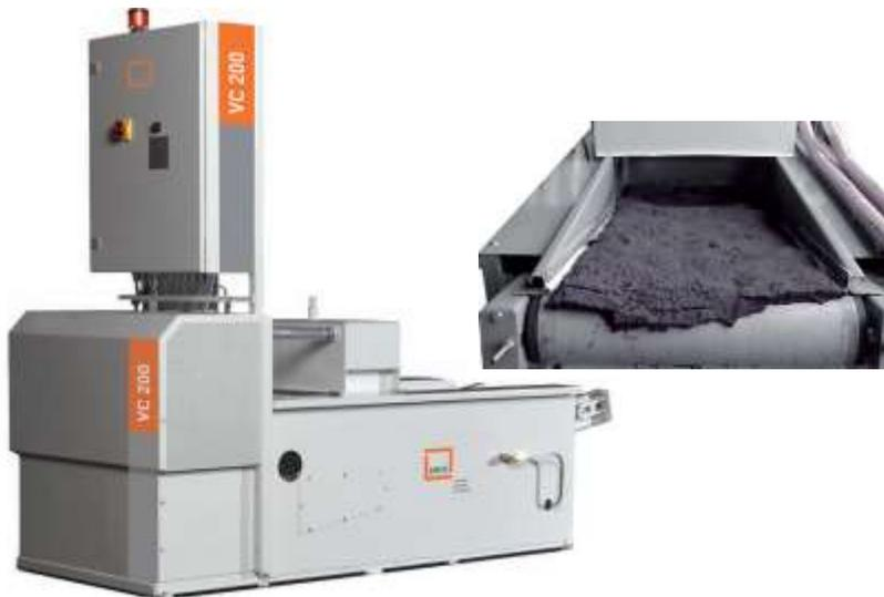
Filtration à bande transporteuse sans fin sous vide avec nettoyage automatique pour machine unitaire ou en îlot Filtration jusque 2  $\mu$ , débit de 300 à 3000 L/Heure
