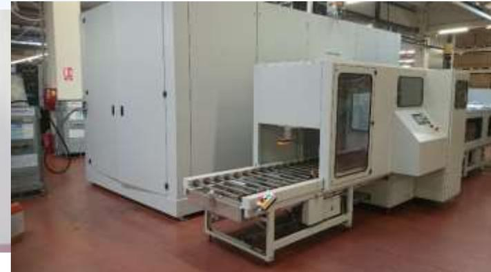
Machine de nettoyage-dégraissage ROLL RCTS 067 avec 2 bains de nettoyage et un bain de regraissage STREIT Mecanique au solvant Non Chlore DOWCLENE 1601
