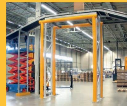
Conceptions de protection haute sur mesure pour les passerelles et les convoyeurs.
