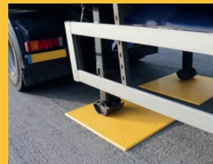
Les plaques de béquillage protègent le béton au niveau des quais de chargement.
