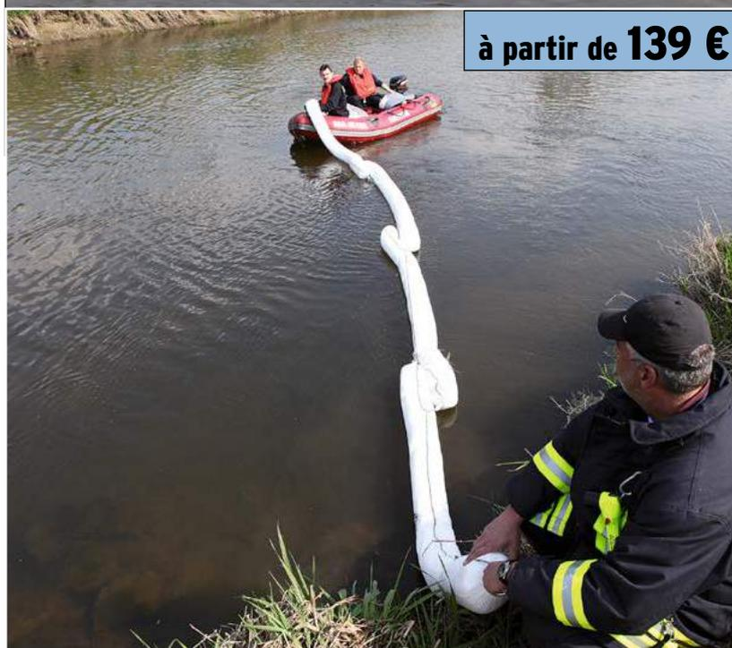
Barrages flottants Densorb (ici : divers éléments de 6 m) pour délimiter et absorber les pollutions d'huile sur les surfaces d'eau.
