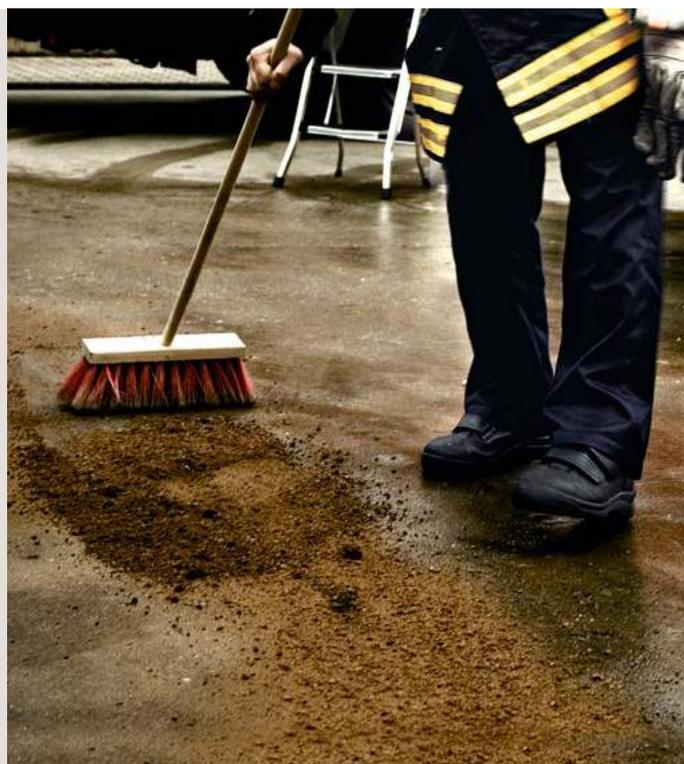
Granulés absorbants et minéraux calcinés spécialement adaptés pour les voies de circulation grâce à leur effet anti-dérapant
