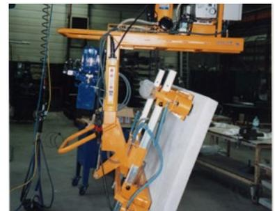
Les palonniers à ventouses **SAPELEM**, certifiés **CE** et **EN** maintiennent les pièces grâce au vide sous un palan ou un chariot. Outils robustes, ils assurent la manutention de produits en toute sécurité. Faciles à utiliser, nos palonniers standard ou sur mesure sont la solution idéale **pour la manutention de charges lourdes.**
