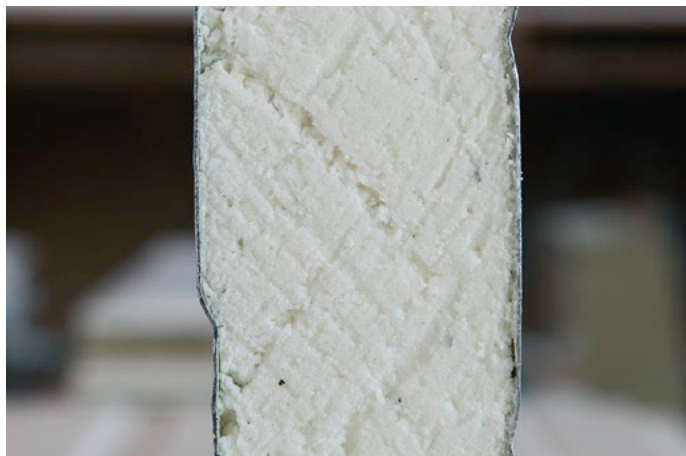
Coupe transversale d'un panneau isolant PU (classe d'inflammabilité B). Ce matériel a de meilleures propriétés isolantes et est ignifuge.
