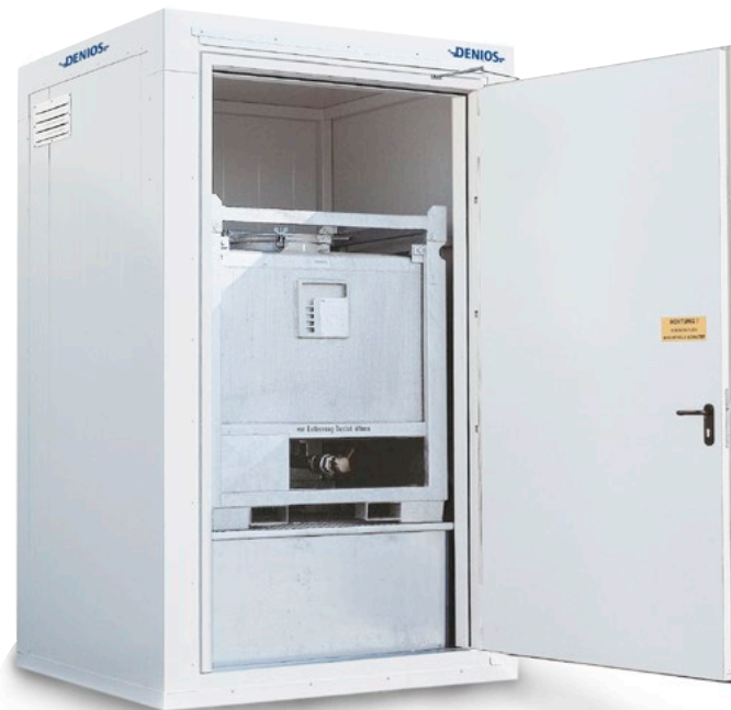
Bungalow coupe-feu BMC-S 180-10 avec un volume de rétention de 1040 litres pour le stockage d'une cuve.
