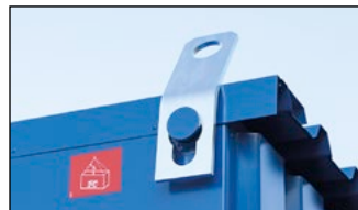
Anneaux de levage, pour le transport par voie terrestre
