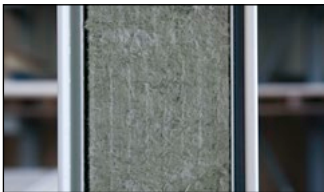
Panneaux coupe-feu en matériau incombustible A (panneaux de laine minérale)
