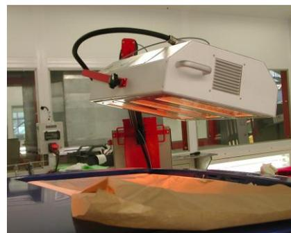
Moyenne densité 30 à 100 KW/m<sup>2</sup>, pour chauffage de produits en défilement ou chauffage localisé.
