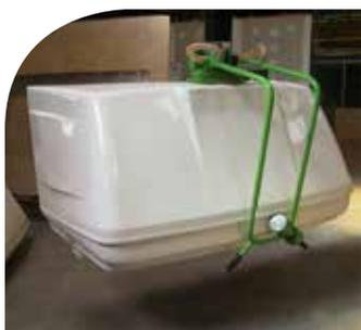
Ventouses adaptées au levage de pièces et carrosseries automobiles
