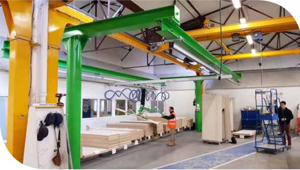
Pont Roulant sur structure en T adapté à l'environnement de travail. Peu d'empattement mais une zone de manutention vaste avec un rail aluminium procurant un confort et une fluidité de déplacement incomparables.
