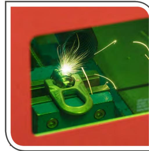
“ Diese Wirbelringschrauben sind zertifiziert und mit einem Sicherheitsfaktor von 5 gekennzeichnet, sodass sie weltweit, auch in Nordamerika, genutzt werden können. Zudem stellt CODIPRO alle nötigen Informationen zur Verfügung, um sie mit dem Sicherheitsfaktor 4, gemäß der Norm EN 1677-1, nutzen zu können. ”
