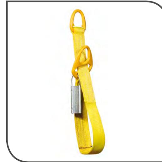
“ LIFTEUROP bietet mehrere Ausführungen dieses Polyamid Hebebandes an: mit Textilschlaufen oder Metallbügeln. Mehrere Schlaufen stehen zur Wahl (flach, eingelegt, usw.). Einfache Bügel und Durchsteckbügel sind ebenfalls erhältlich. Wenn es mit Bügeln versehen ist, bietet das Hebeband einen Sicherheitsfaktor von 6. Das STAS-FLEX Hebeband kann in der Anschlagart „einfach umlegt“ oder „geschnürt“ genutzt werden. ”
