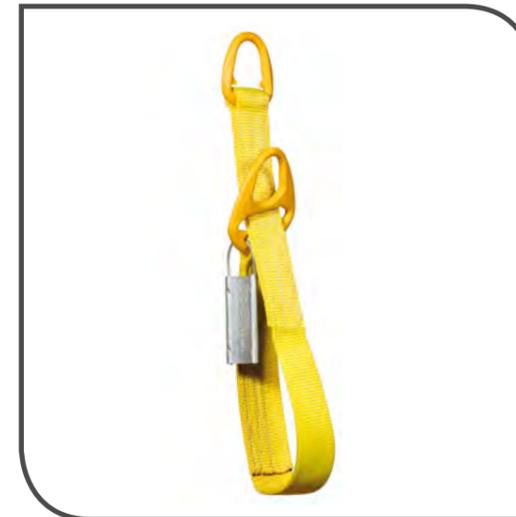
“ LIFTEUROP propose plusieurs variantes pour cette élingue polyamide : avec des boucles textiles ou des attaches métalliques. Il existe plusieurs types de boucles (à plat, repliées, etc.) ou des attaches métalliques simples et coulissantes. Avec les attaches, elle offre un coefficient de sécurité 6. L'élingue STAS FLEX peut s'utiliser en configuration type « anse de panier » ou « nœud coulant ». ”
