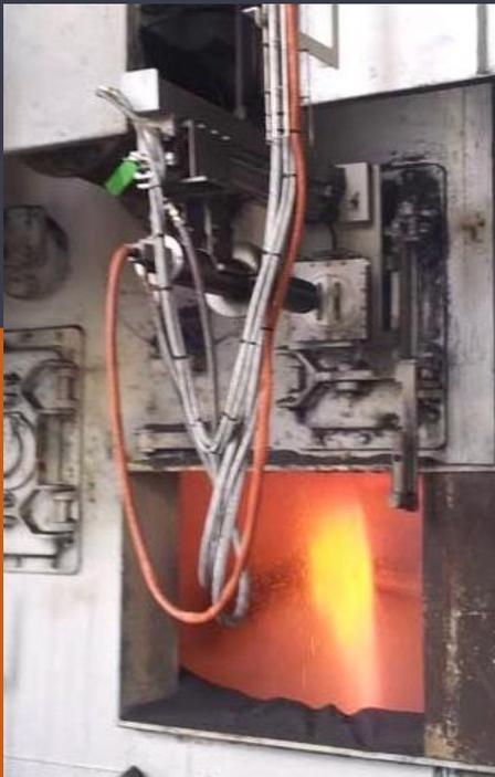
Suivre la température dans un four tournant ou dans une chambre de combustion pour maîtriser la température et réduire les dépenses énergétiques de votre usine de traitement et valorisation des déchets est possible.
