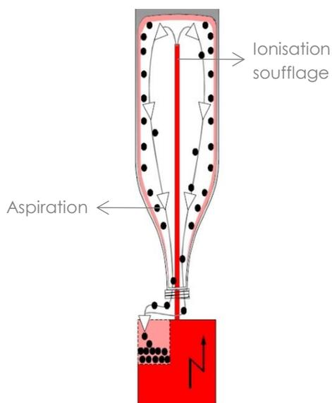
> L'aspiré soufflé est un **système complet d'ionisation** permettant de souffler de l'air ionisé pour **supprimer l'électricité statique** contenue dans le flacon et **chasser les poussières** s'y trouvant.
