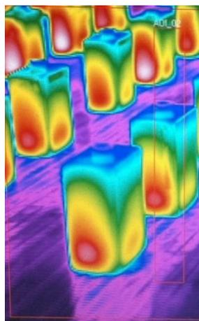
Nos solutions de mesure de température, sans contact, pour s'assurer de l'homogénéité thermique de votre production de verre ou matière plastique. Nos pyromètres infrarouges, scanners et caméras thermiques sont indispensables pour maîtriser la température dans votre process et garantir la qualité de votre production.
