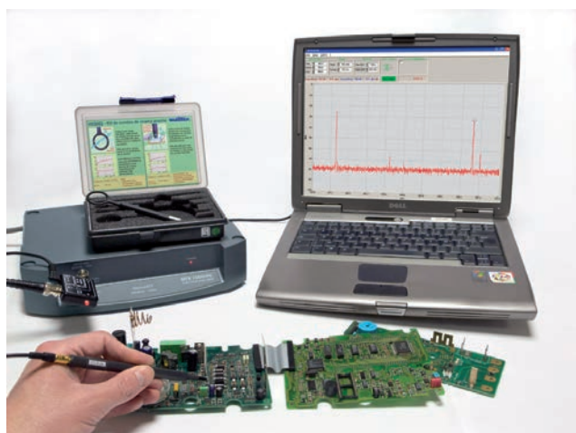
Mesures avec sonde de contact HX0082
