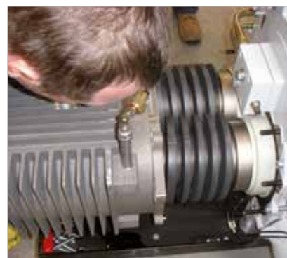
La SCREWLINE permet un accès facile aux vis pour un nettoyage par l'utilisateur sur site
