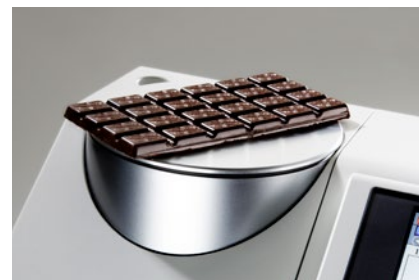
CM-5 en mode Réflexion pour produits opaques
